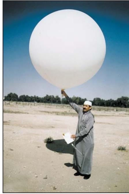
بالون هوائي يحمل جهازاً لاسلكياً يطلق مرتين يومياً في سماء مدينة الرياض ليرسل معلومات عن مناخ طبقات الجو العليا
