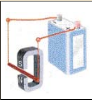
شكل (١٠ - ٩) تأثير المجال الكهربائي على المغناطيس
